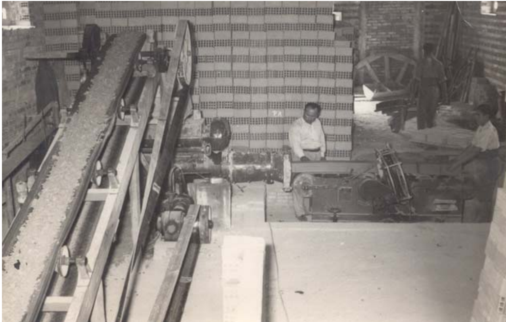
Antonio Malpesa, padre del actual presidente, puso los cimientos para el crecimiento futuro. Aquí, observa la antigua extrusora de ladrillos (año 1955)
